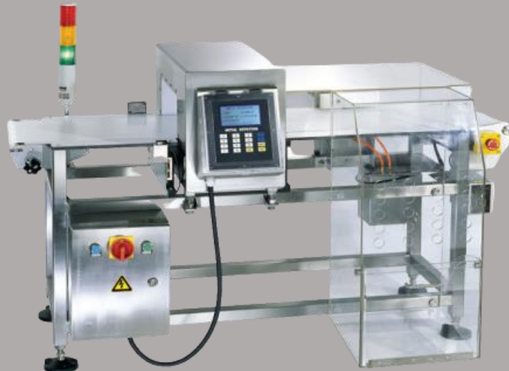
Metalldetektor (prüft bis zu 100 Stück/Min)
